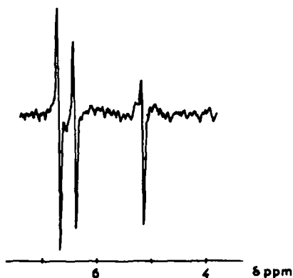
Fig. 4. Spectre enregistré après 5 minutes d'irradiation de l'anthracène + CCl 4 dans CD 3 CN.
